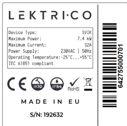
Fig. 2 Étiquette de produit de la borne LEKTRI.CO 1P7K
