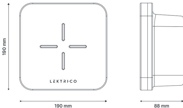
Fig. 12 - Dimensions totales de la borne de recharge
